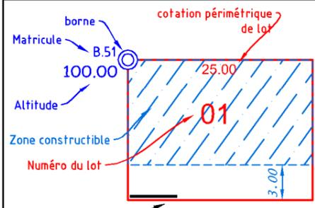
Nota: Il est impératif de s'appuyer sur le nivellement fourni par le Géomètre suite au bornage du lot.
